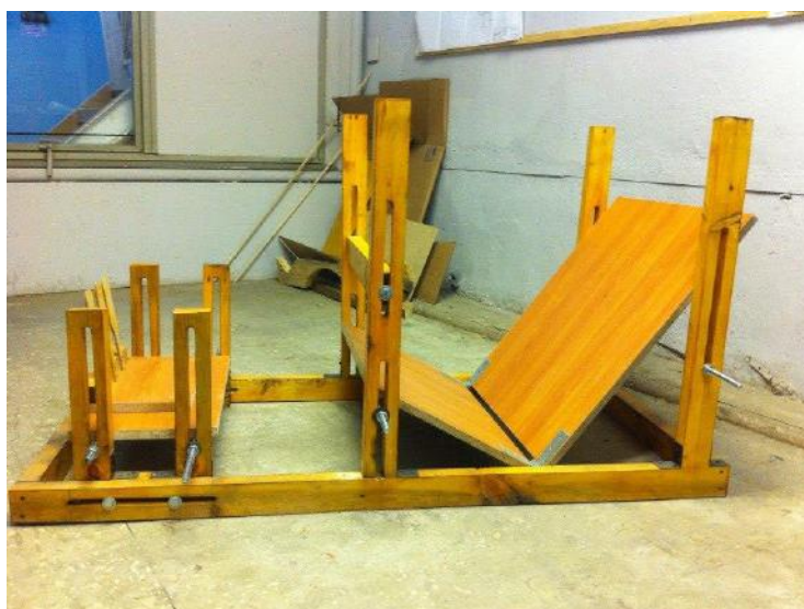
Рис. 1. Макет для анализа положения пилота «Формула Студент» ПНИПУ
