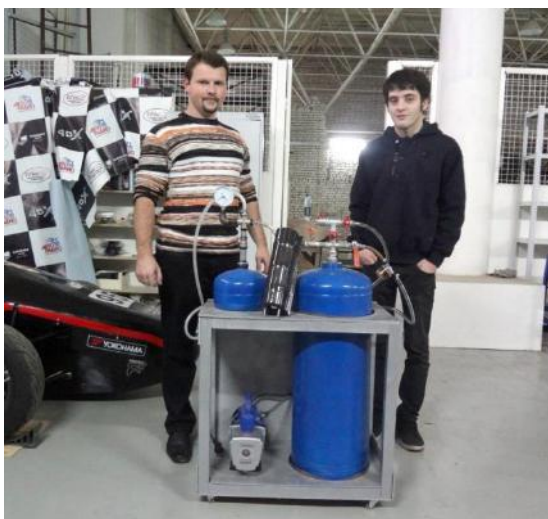
Рис. 1. Установка для вакуумной инфузии, созданная участниками СКБ «Формула Студент»
