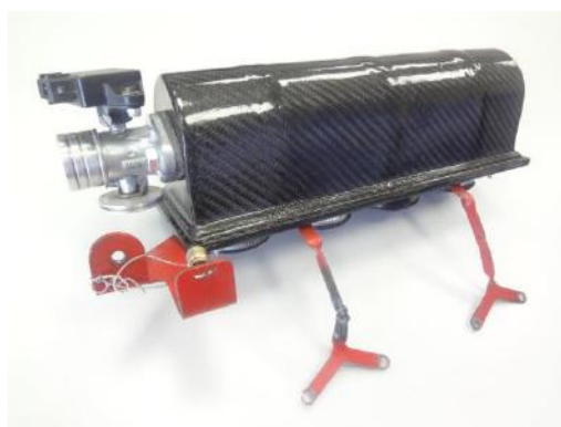
Рис. 2. Ресивер впускной системы выполненный на основе углеродного волокна
