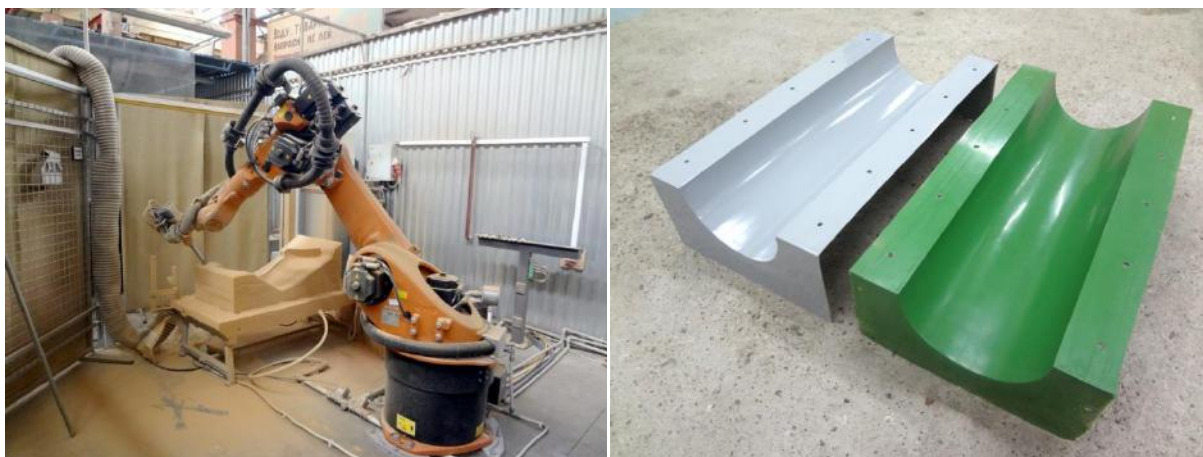
Рис. 4. Создание технологической оснастки для получения элементов несущих систем и компонентов с использованием технологий цифрового производства и быстрого прототипирования
