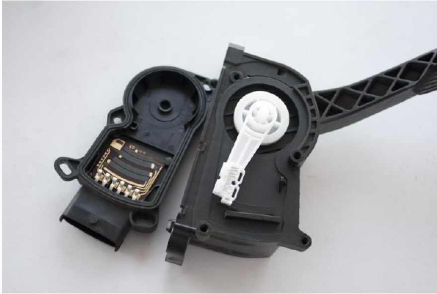
Рис. 3. Собачка с контактами(белая) и плата с двойным датчиком
