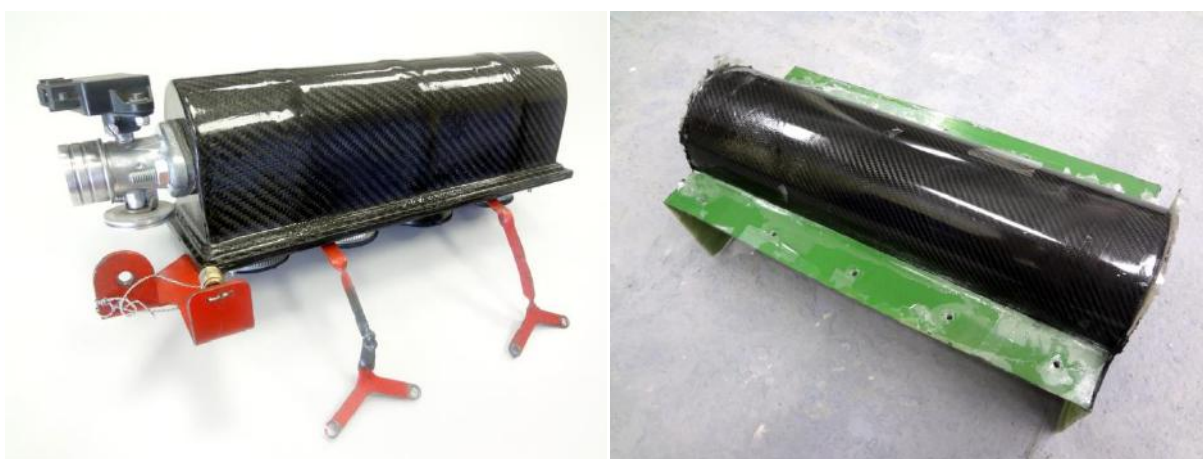
Рис. 5. Создание компонентов спортивных автомобилей класса «Formula Student» на основе композиционных материалов (элементы впускной и выхлопной системы)
