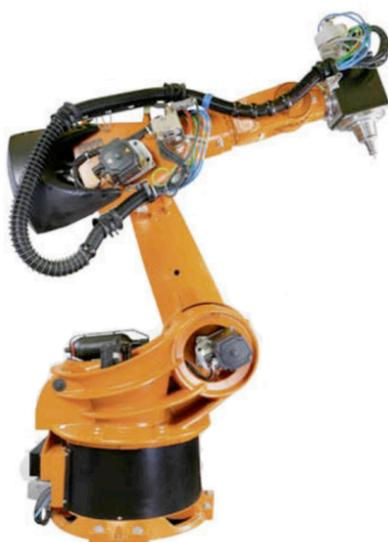
Рис. 1. Роботизированный фрезерный комплекс KUKA Milling
