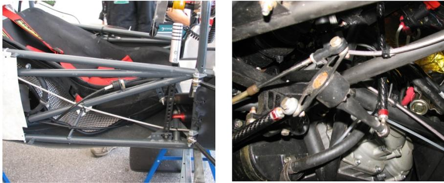
Рис.2. Механическая тросовая и рычажная система переключения скоростей
