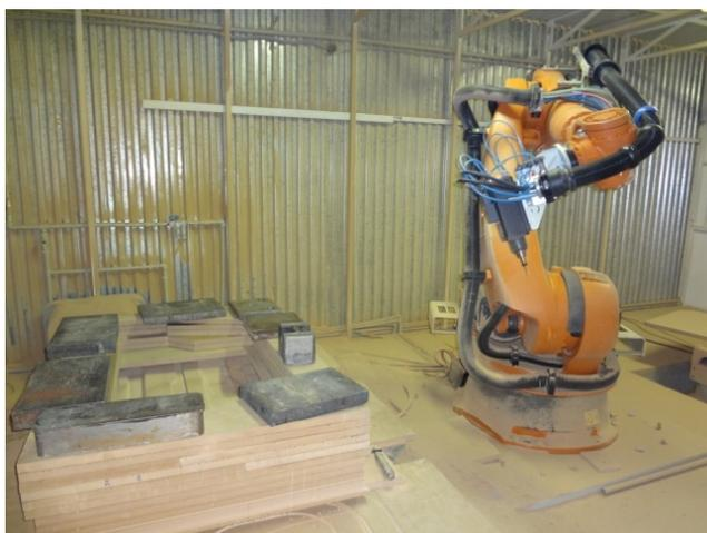
Рис. 2. Обработка заготовки оснастки для создания аэродинамического обвеса
