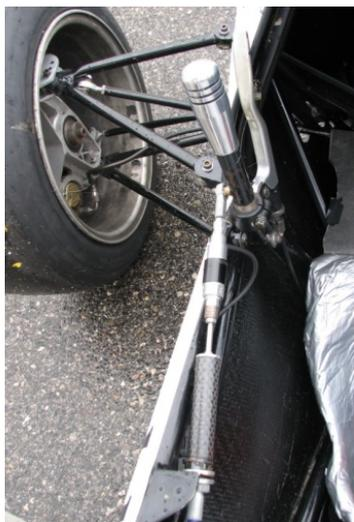
Рис.1. Гидравлическая система переключения скоростей
