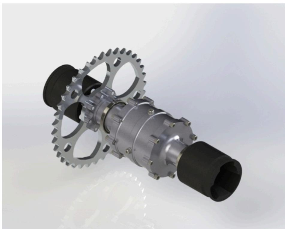
Рис. 1. Разработанный дифференциал дискового типа
